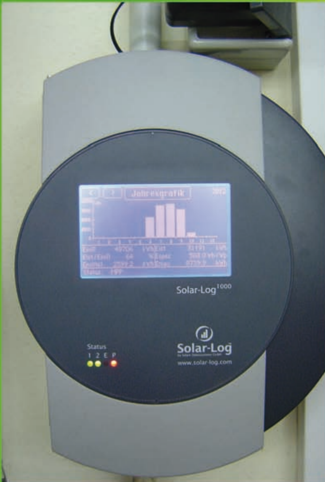
Datenlogger mit Internet- anbindung und Fernüberwachung
